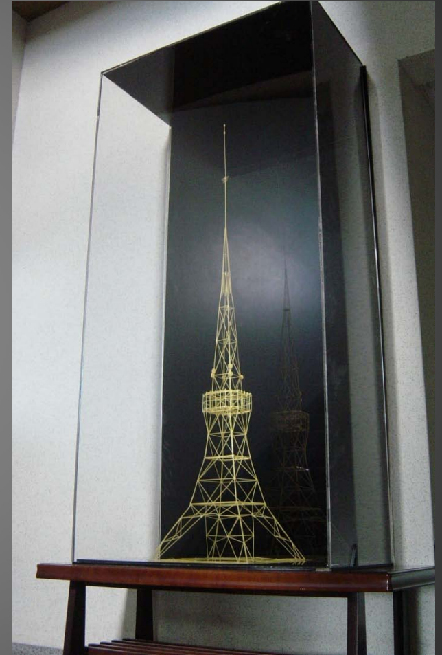
試作したスパゲティタワー
