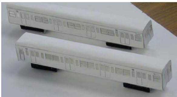
図3 台車のない試作のホワイトモデル車両。
